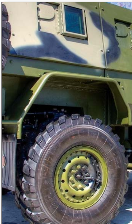
Хидраулични систем за ослањање шочкова омогућује возачу да каросерију „волка“, од основног положаја са клиренсом од 400 mm, подиже и спушта до 150 mm
